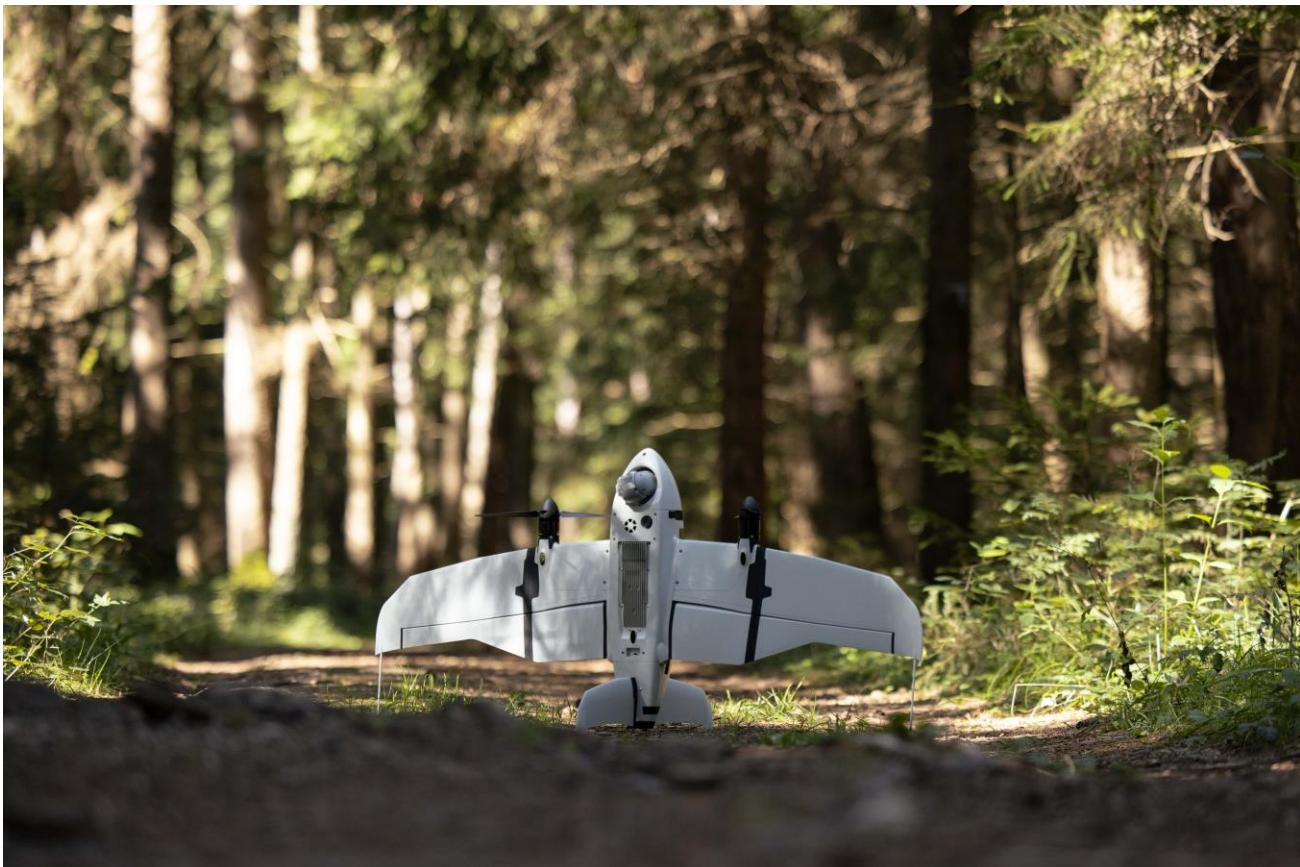
Das Twister-System ist ein elektrisch angetriebener eVTOL (electric Vertical Take-Off and Landing) sUAS, der speziell für taktische Aufklärungsmissionen auf Gruppen- und Zugebene entwickelt wurde. Mit einem maximalen Abfluggewicht von 4 kg, einer Flugdauer von 90 Minuten und einer Reichweite von 15 km liefert Twister Echtzeit-Luftaufklärung.
